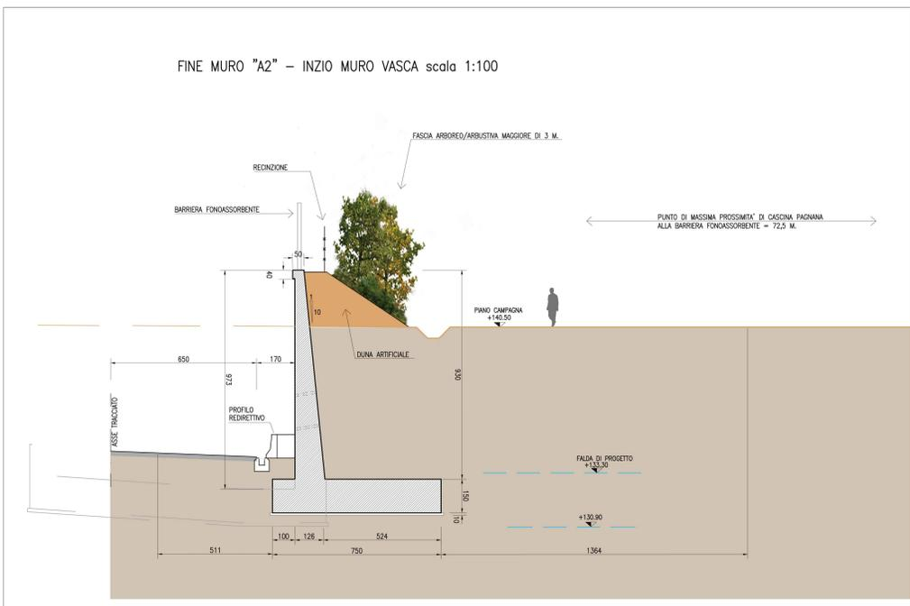
DETtaglio SEZIONE TRASVERSALE IN CORRISPONDENZA DELLA MASSIMA PROSSIMITA' DELLA CASCINA ALLA BARRIERA FONOSORBENTE - SCALA 1:100
