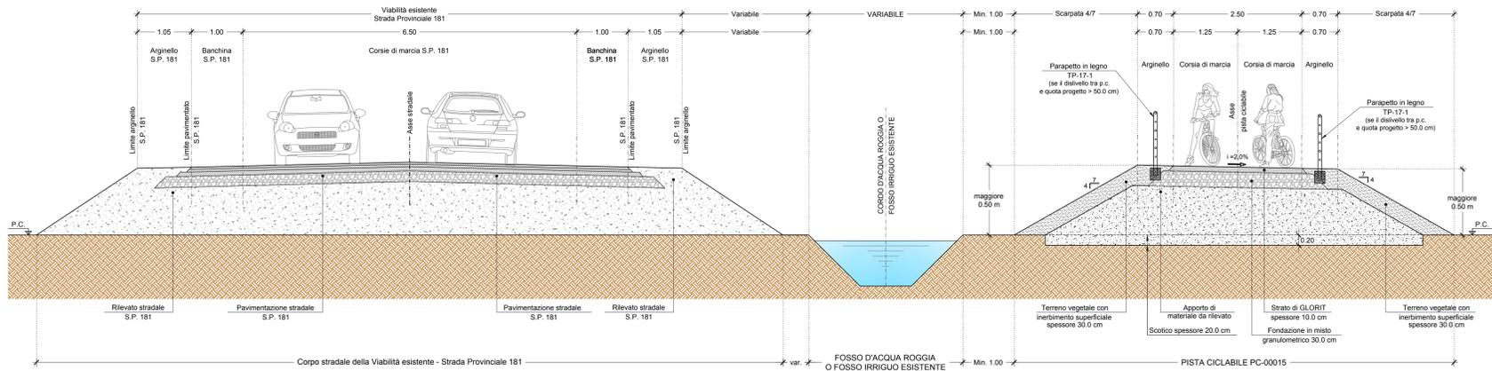
**SEZIONE TIPO "F2" - Percorso ciclabile in Glorit in con filare alberato sul ciglio destro e canale adacquatore in destra**
