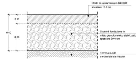
**PARTICOLARE DELLA PAVIMENTAZIONE PIAZZOLE DI SOSTA**
