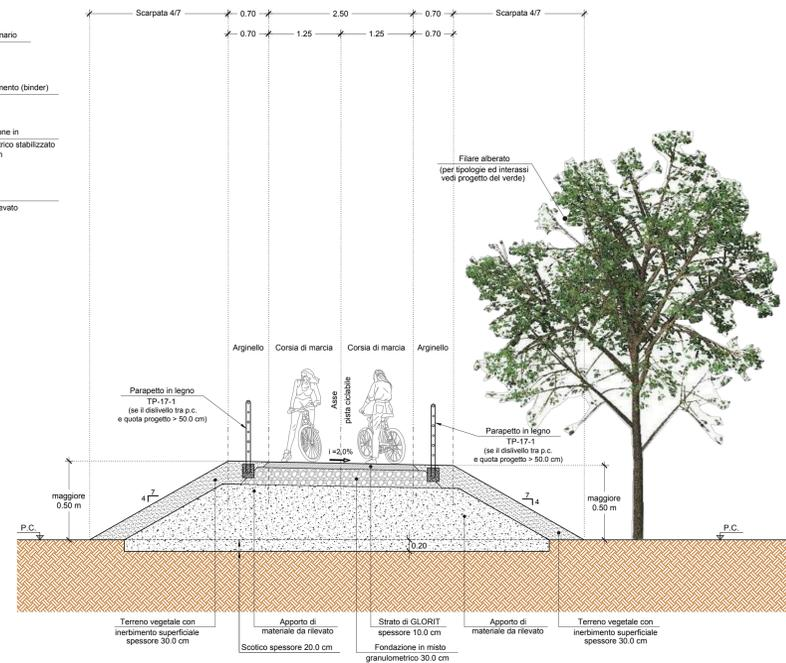
**PARTICOLARE DELLA PAVIMENTAZIONE IN GLORIT DA REALIZZARE PER LO SVILUPPO DELL'INTERA PISTA PC-00015**
