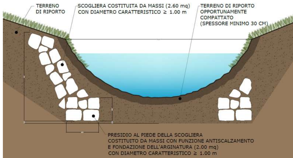
Figura 32 - Sezione scogliera in massi contro gli effetti erosivi
