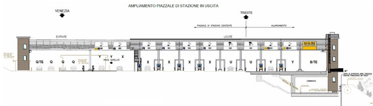
Figura 4 - Sezione schematica delle piste di esazione nella configurazione di progetto. (Q=entrata automatica+Telepass, TE=trasporti eccezionali, B=uscita Telepass, U=uscita manuale, X=uscita manuale+cassa automatica, Y=uscita manuale+cassa automatica+Telepass).
