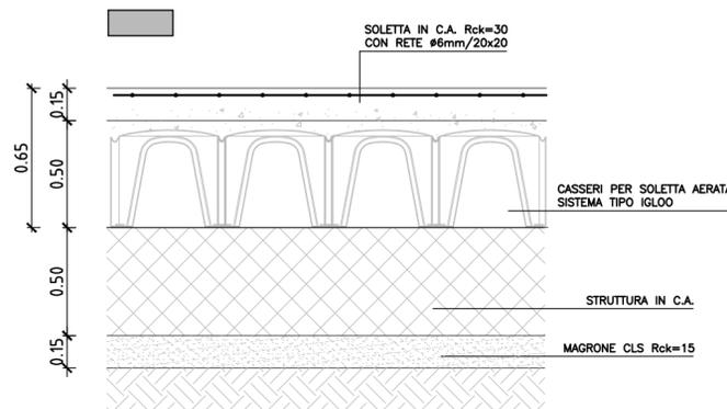
PARTICOLARE SOLAIO DI COPERTURA
