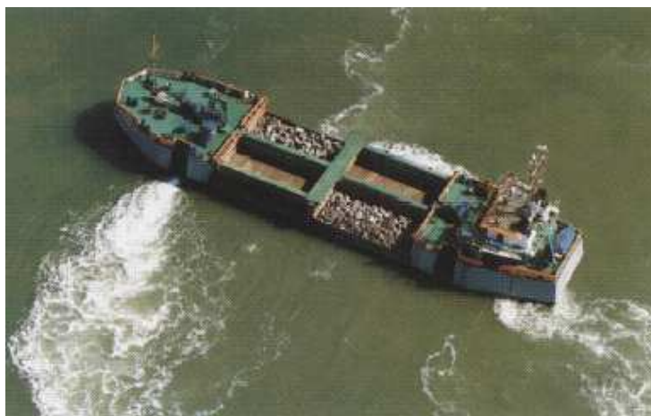
Figura 4.21 – Imbarcazione utilizzata per la messa in opera a mare del materiale ghiaioso e pietrisco.
