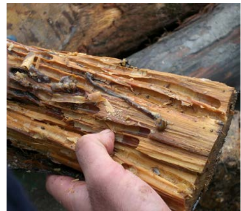
Figura 3-1 Palificata degradata dall'azione delle teredini, che perforano e penetrano in senso longitudinale all'interno del palo (Magistrato alle Acque - CVN-SI, 2008).
