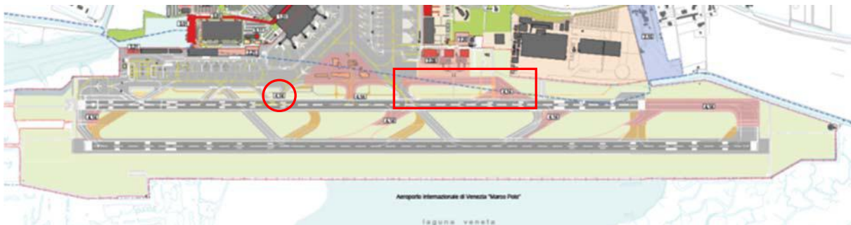
Figura 21. Configurazione airside al 2016: Interventi di demolizione e ricostruzione dei raccordi e della pista previsti nel Masterplan – Intervento 4.14 "Riqualfica e adeguamento normativo infrastrutture di volo".
