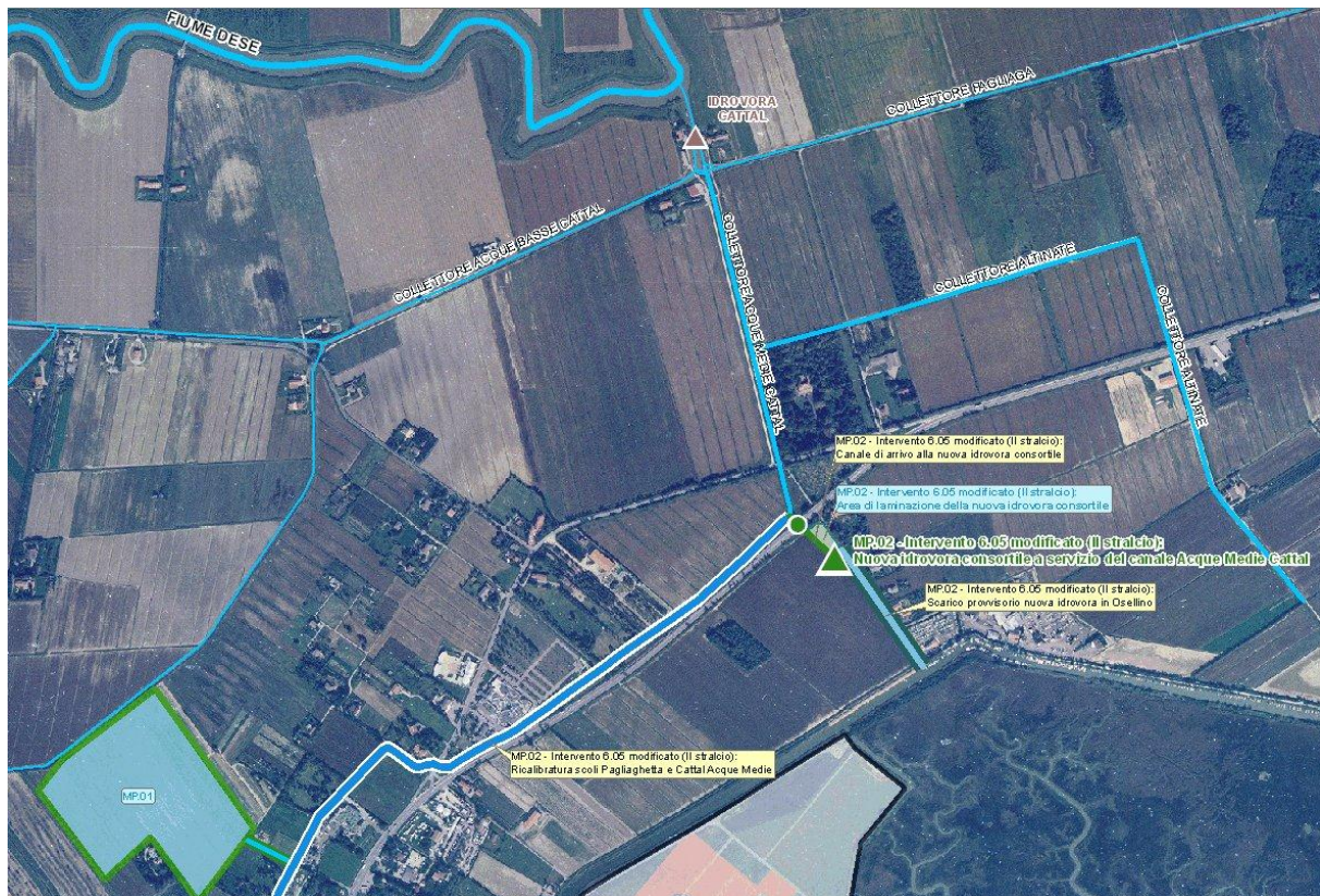
Figura 26. Interventi previsti dal Masterplan idraulico al 2021: completamento della ricalibratura del Canale Acque Medie Cattal, dall'Area di espansione MP.01 fino alla derivazione alla nuova idrovora consortile, e nuova idrovora del Consorzio Acque Risorgive e opere annesse.
