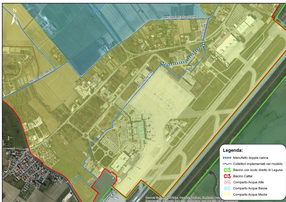
Figura 6.3. Rete di collettori entro il sedime aeroportuale implementati nel modello idraulico nella configurazione impiegata per la calibrazione.
