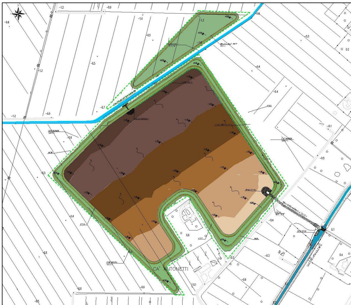
Figura 7 - stato di progetto. In verde è evidenziato l'argine in progetto, in marrone l'area adibita ad invaso (le zone più scure sono quelle con maggiore profondità).
