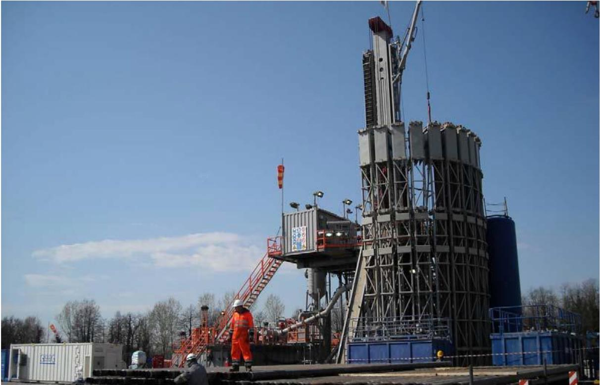
Figura 3-7: Impianto Drillmec HH 200, particolare della torre di perforazione (Fonte: Drillmec)
