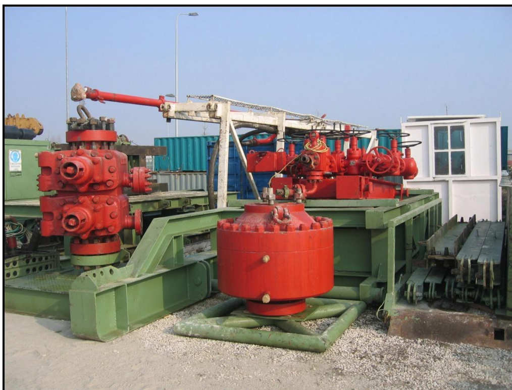
Figura 5.4.2a Esempi di BOP “Ram” (a Sinistra) e “Annular” (a Destra)
