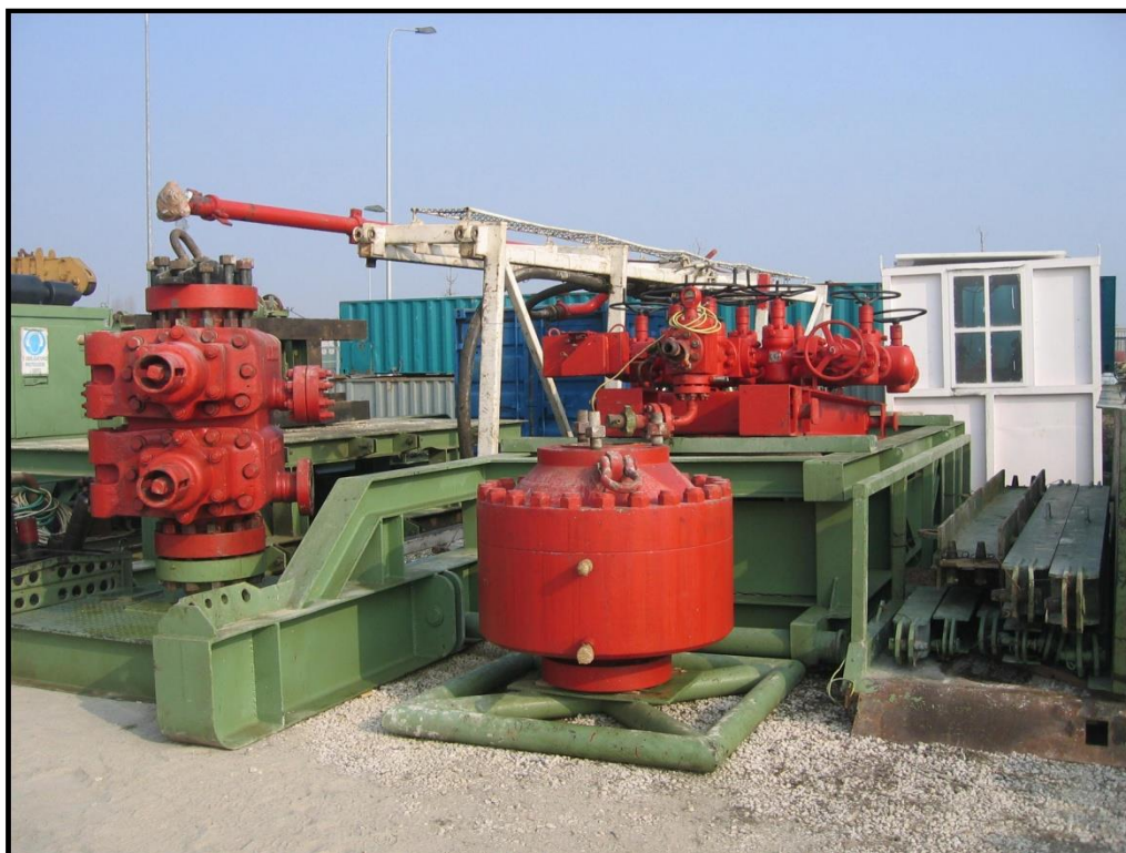
Figura 3.4.5.2a Esempi di BOP “Ram” (a sinistra) e “Annular” (a destra)
