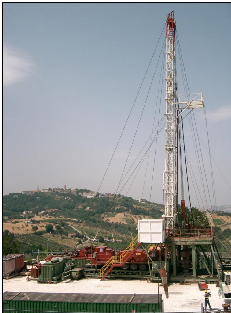
Figura 3.4.3a Esempio di Impianto di Perforazione con Potenzialità 1.500 m
