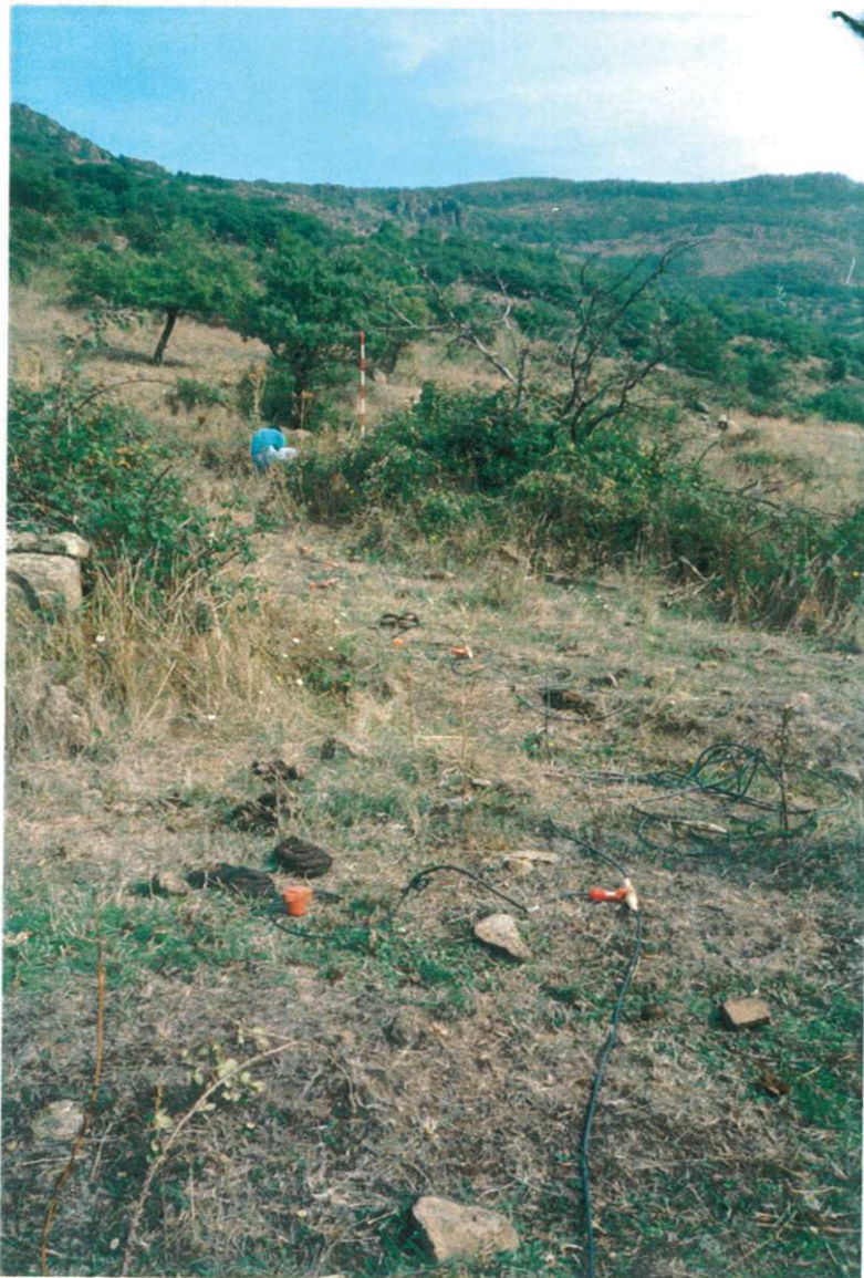
Foto 2 - Panoramica sulla Linea a rifrazione L5 di dettaglio. Fase di stendimento dei cavi sismici ed infissione geofoni.
