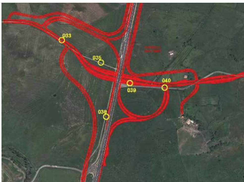
Figura 14. Punti di riferimento per la localizzazione dei siti oggetto delle considerazioni precedenti: punto 040 per la zona dei nuovi tracciati per ingresso e uscita in corsia nord; punti 035 e 039 per le aree di sedime del rilevato relativo al nuovo cavalcavia in progetto; punto 033 per l'uscita dalla corsia sud; punto 038 per l'ingresso nella corsia sud.
