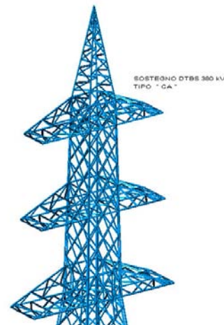
sostegno CA – Particolare della testa
