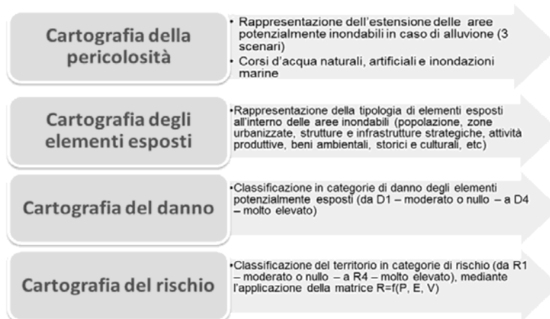
Figura. Fasi di definizione delle mappe della pericolosità e del rischio di alluvioni.
