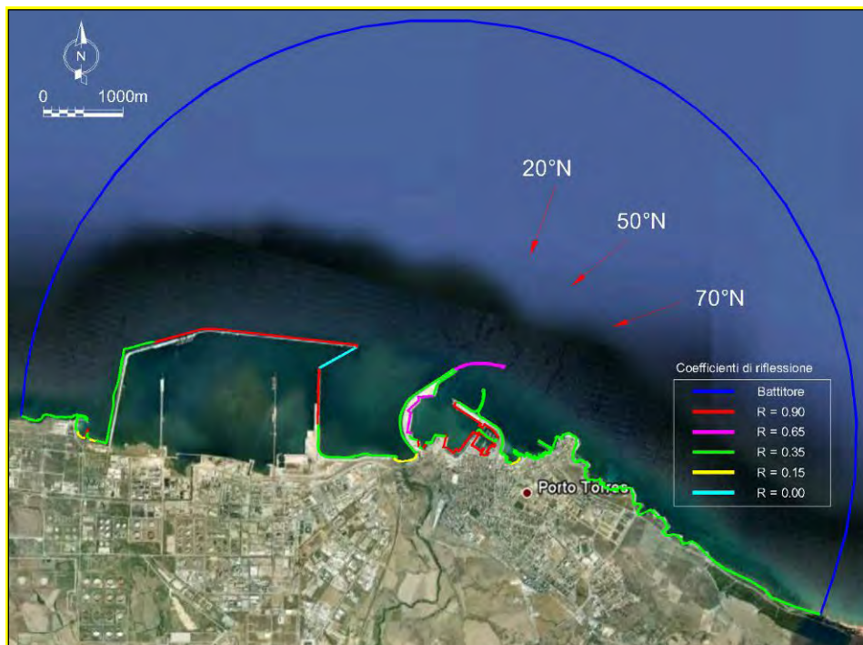
Figura 3-4: Configurazione di Adeguamento Tecnico Funzionale: indicazione dei coefficienti di riflessione adottati per le simulazioni effettuate con il modello CGWAVE
