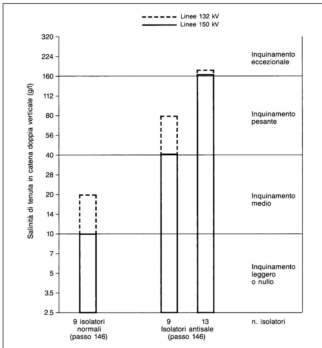
Per le linee che attraversano zone prive di inquinamento atmosferico è previsto l'impiego di catene (di sospensione o di amarro) composto da 9 elementi di tipo "normale".
