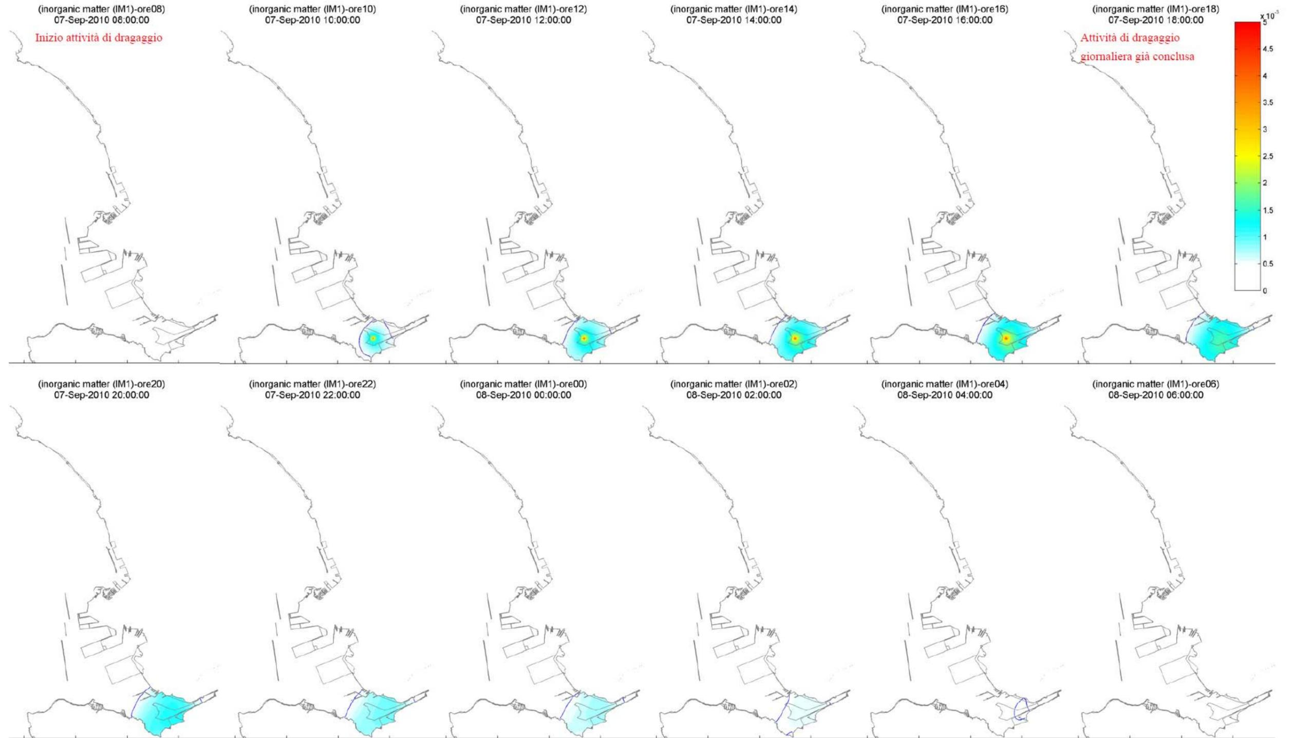
FIGURA 2-5 – PUNTO DI RILASCIO P1 -DISTRIBUZIONE DELLA CONCENTRAZIONE DI SOLIDI SOSPESI (G/M<sup>3</sup>) PER LO SCENARIO CON LA MAREA MEDIA E ASSENZA DI VENTO.
