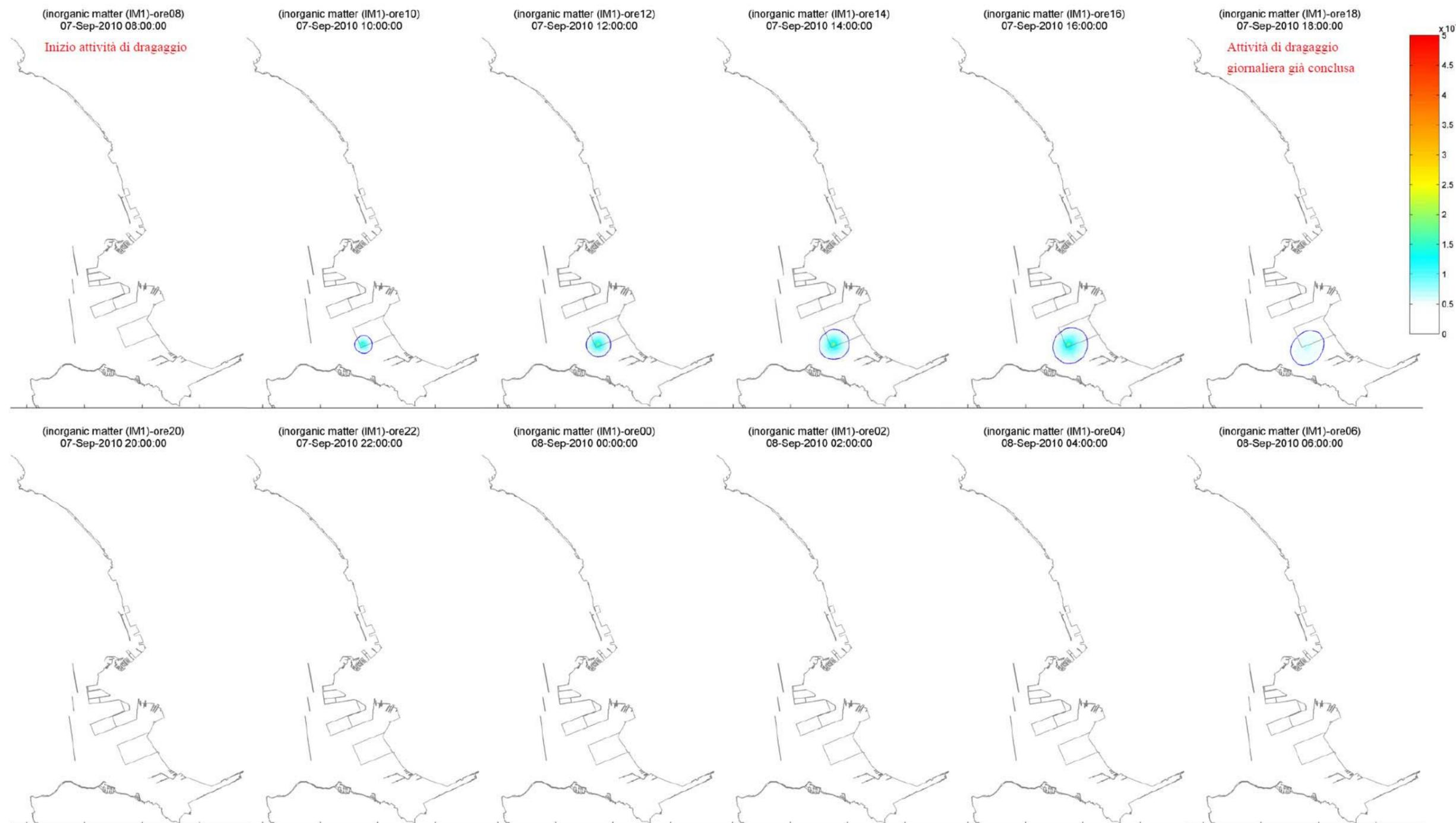
FIGURA 2-10 – PUNTO DI RILASCIO P3 -DISTRIBUZIONE DELLA CONCENTRAZIONE DI SOLIDI SOSPESI (G/M<sup>3</sup>) PER LO SCENARIO CON LA MAREA MEDIA E VENTO DI BORA.
