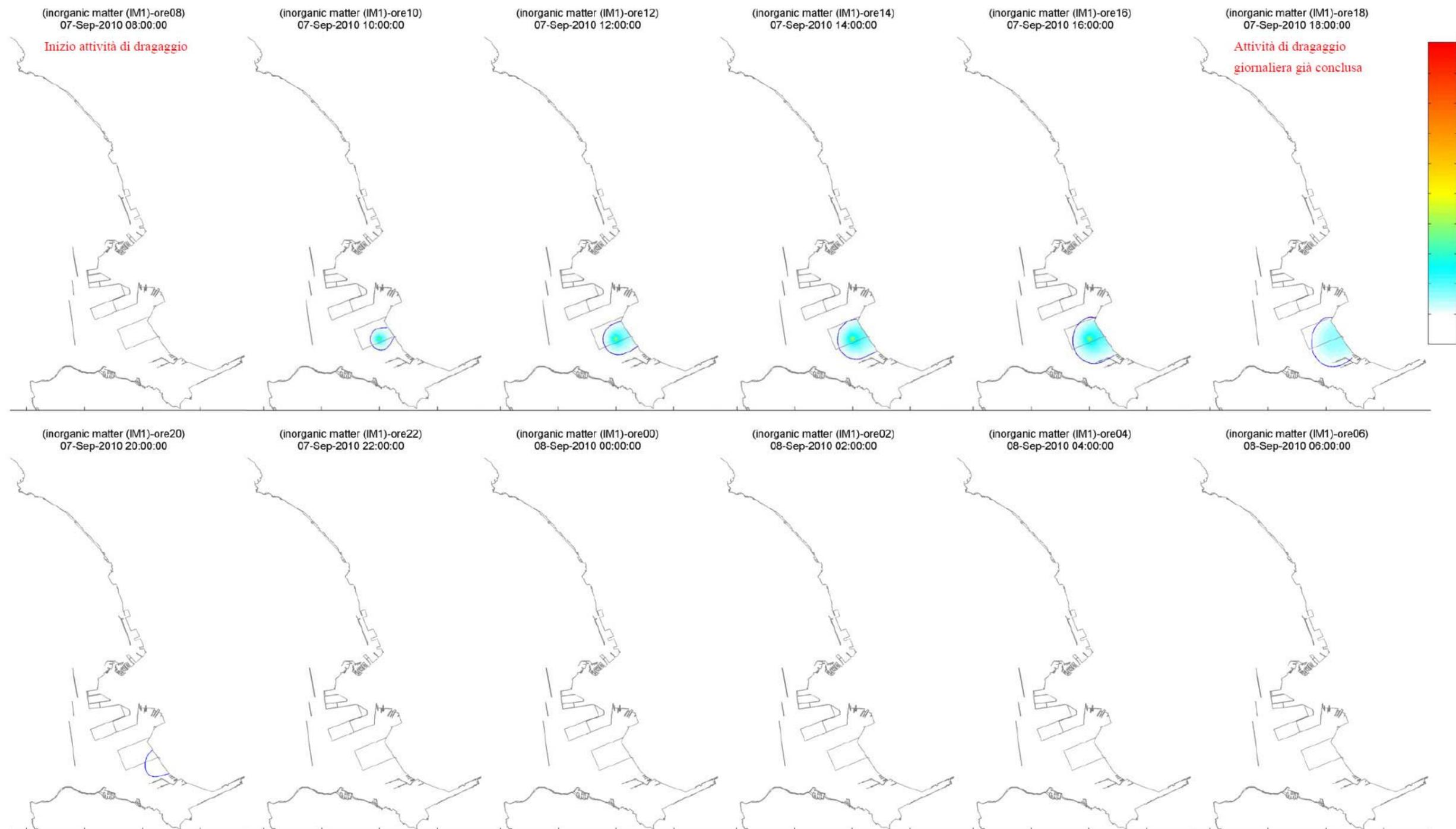
FIGURA 2-9 – PUNTO DI RILASCIO P2 -DISTRIBUZIONE DELLA CONCENTRAZIONE DI SOLIDI SOSPESI (G/M<sup>3</sup>) PER LO SCENARIO CON LA MAREA MEDIA E VENTO DI BORA.
