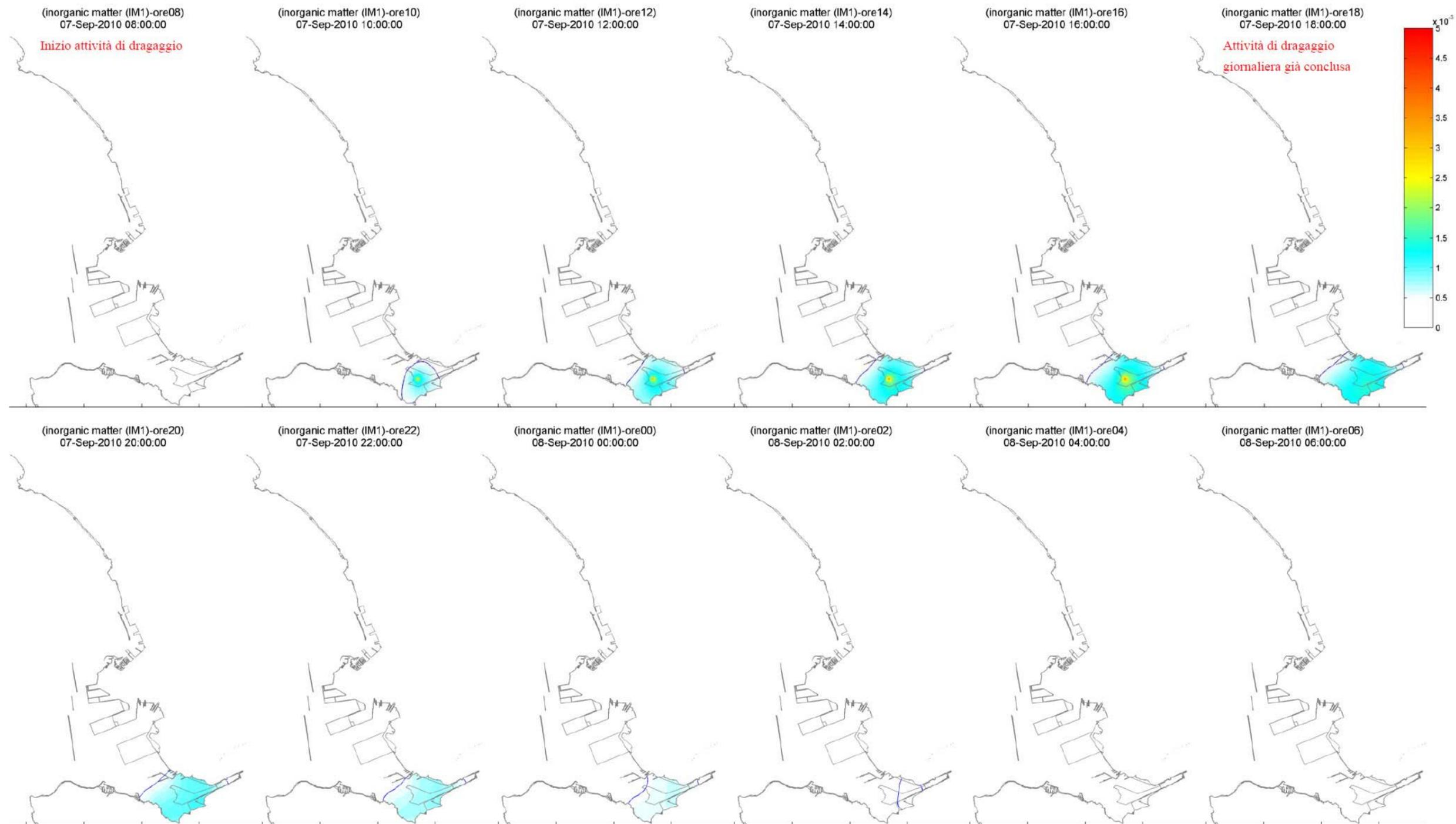
FIGURA 2-8 – PUNTO DI RILASCIO P1 -DISTRIBUZIONE DELLA CONCENTRAZIONE DI SOLIDI SOSPESI (G/M<sup>3</sup>) PER LO SCENARIO CON LA MAREA MEDIA E VENTO DI BORA.
