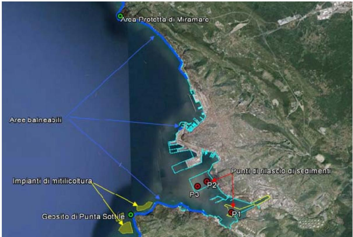
FIGURA 2-4 - ZONA DI INTERESSE PER LE ANALISI DI DISPERSIONE DEI SEDIMENTI MESSI IN SOSPENSIONE DALLE ATTIVITÀ DI DRAGAGGIO .
