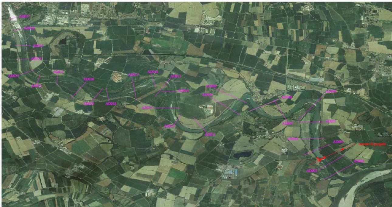
Figura 2. 8: Ortofoto dell'area di interesse con l'indicazione delle sezioni desunte dal PAI e la sezione di progetto. L'area modellizzata ai fini del presente studio si estende dal ponte ferroviario di Piazzighettone (monte) a poco a monte della confluenza in Po (valle).
