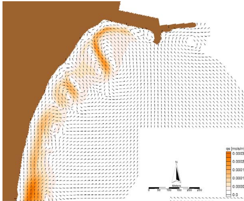
Figura D. 17 - Distribuzioni del trasporto solido indotto dal moto ondoso -Caratteristiche del moto ondoso al contorno: H_s = 2.90 m, T_p = 7.26 s, Dir = 110.27^\circ N, f = 0.27\% . Vista generale, scenario 3.
