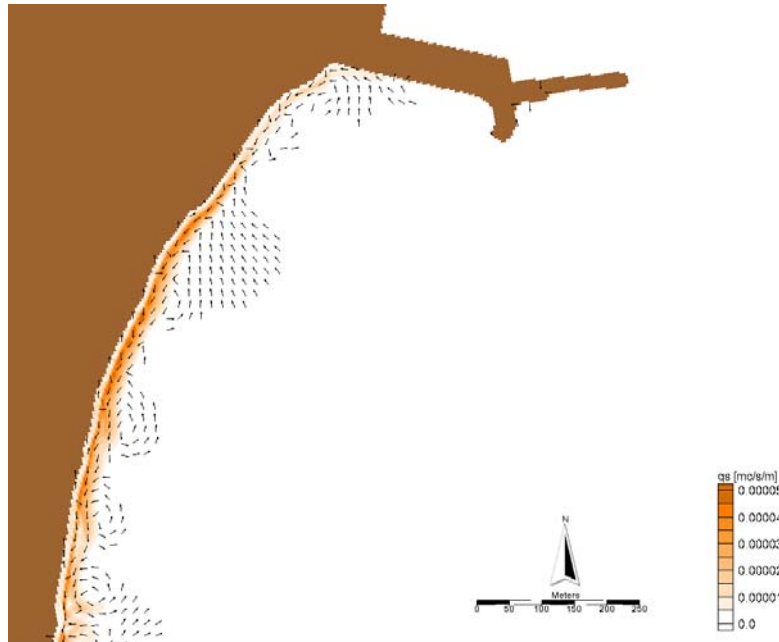
Figura D. 15 - Distribuzioni del trasporto solido indotto dal moto ondoso -Caratteristiche del moto ondoso al contorno: H_s = 1.19 m, T_p = 4.66 s, Dir = 90.33^\circ N, f = 10.58\% . Vista generale, scenario 3.
