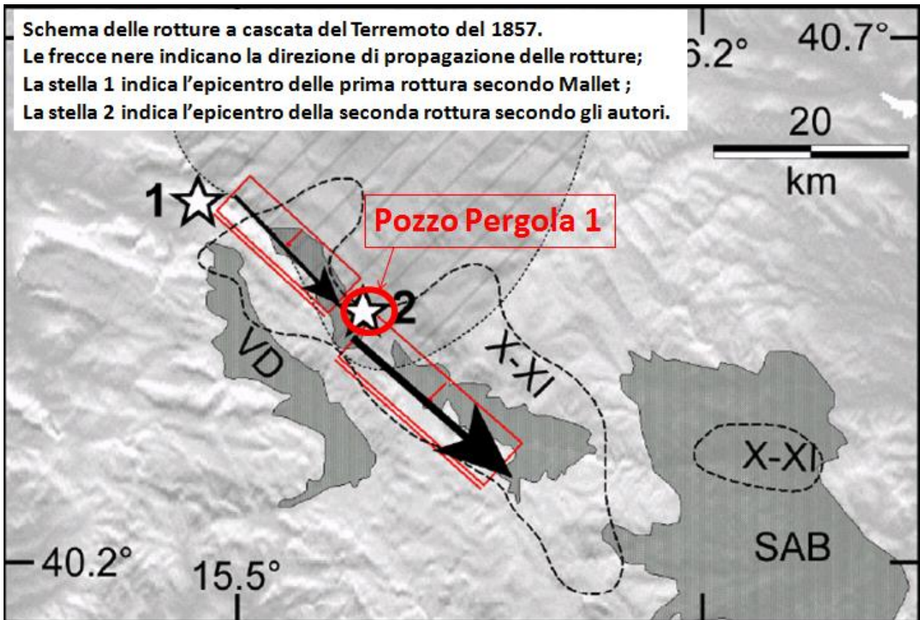
Figura 3: ricostruzione della riattivazione a cascata delle faglie sismogenetiche della valle del Melandro e dell'alta val d'Agri in occasione del sisma del 1857. Gli autori evidenziano che la prima rottura si sarebbe verificata nella parte nordoccidentale della valle del Melandro propagandosi verso sudest nella zona dove è previsto il pozzo Pergola 1. Proprio da questa zona sarebbe iniziata la riattivazione della seconda faglia. E' importante fare rilevare che le faglie propagandosi verso sud est determinano una marcata direttività che causa, come è noto in letteratura, una accentuazione delle sollecitazioni sismiche che causano effetti locali altamente distruttivi e imprevedibili. E' evidente che il sito del Pozzo Pergola 1 rappresenta una zona che può essere interessata da effetti locali altamente distruttivi accentuati da discontinuità delle caratteristiche geomeccaniche del substrato, sia orizzontalmente che verticalmente. A tale pericolosa situazione non viene fatto alcun riferimento nello studio VIA.
