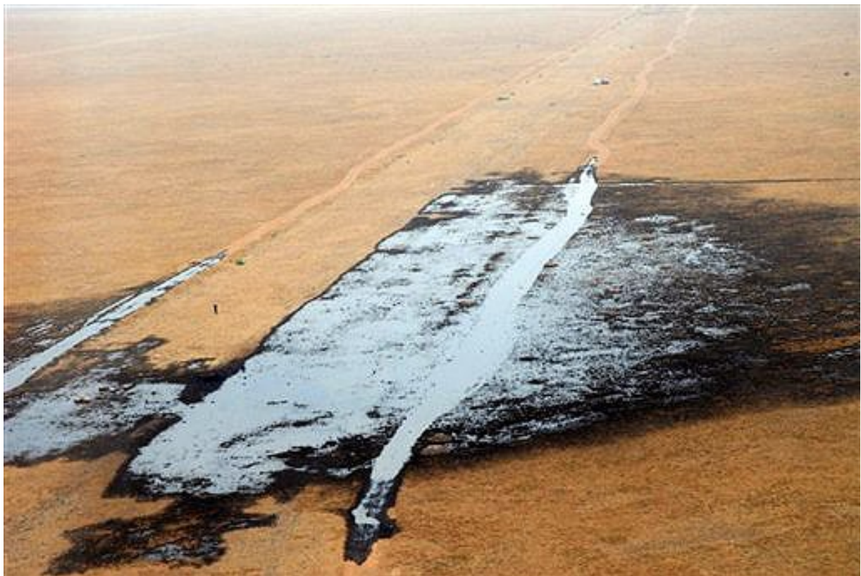
Fig. 13 - Una frana in Ecuador ha coinvolto e rotto l'oleodotto Trans-Ecuador, causando la fuoriuscita di 205.000 litri di olio greggio e l'inquinamento del territorio circostante.
