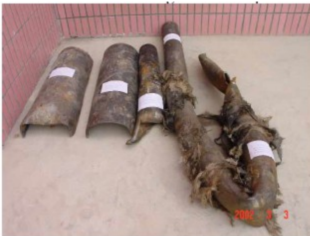
Fig. 26 - Danni subiti dalla condotta durante il terremoto del 2001 vicino a Qinghai-Xinjiang, Cina.
