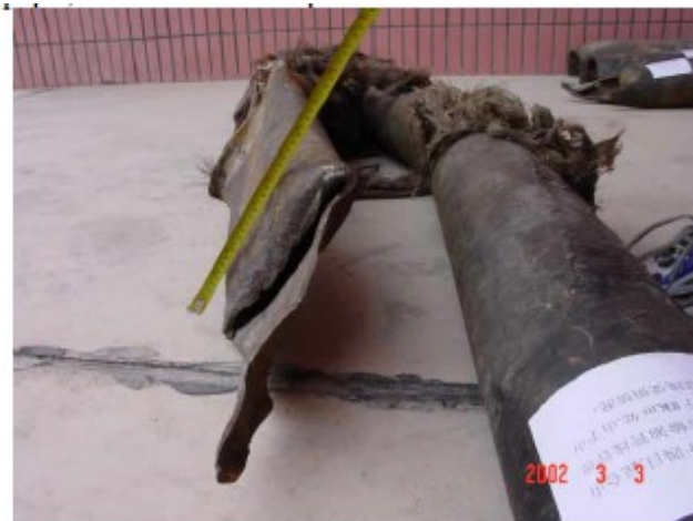
Fig. 26 - Danni subiti dalla condotta durante il terremoto del 2001 vicino a Qinghai-Xinjiang, Cina.
