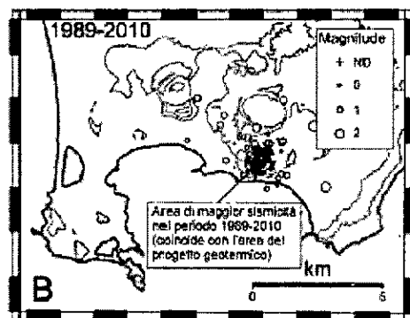
Figura 4: Localizzazione dei terremoti dei Campi Flegrei nel periodo 1989-2010. I cerchi blu indicano gli epicentri dei terremoti la cui magnitudo è riportata in legenda. Nella figura, che è ripresa dal lavoro scientifico D'Auria et al. (2011), è evidente che il previsto impianto geotermico è stato progettato nell'area di maggior sismicità recente dei Campi Flegrei.
