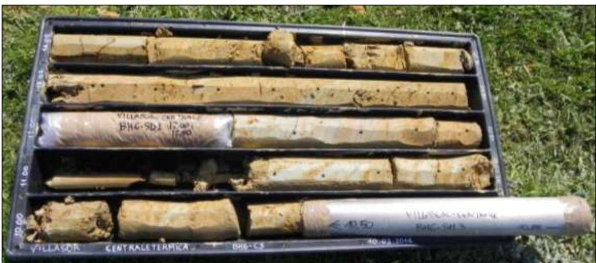
FOTO 7 – Sedimenti dello Strato C estratte dal sondaggio BH6 (10,00-15,00 m da p.c.)
