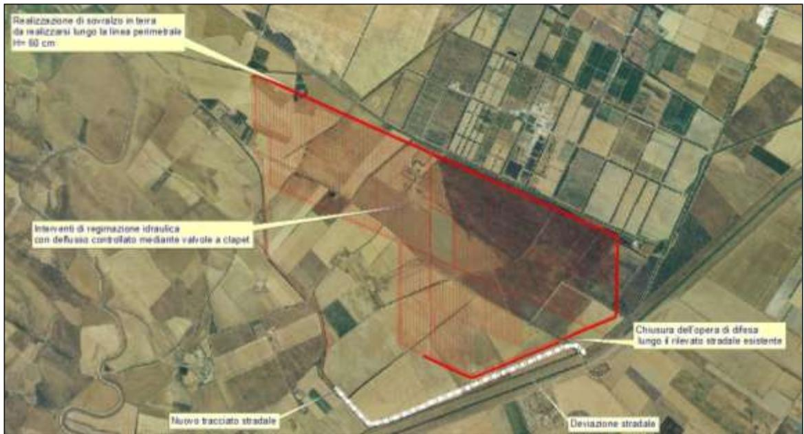
FIGURA 29 – Schema planimetrico delle opere di mitigazione.
