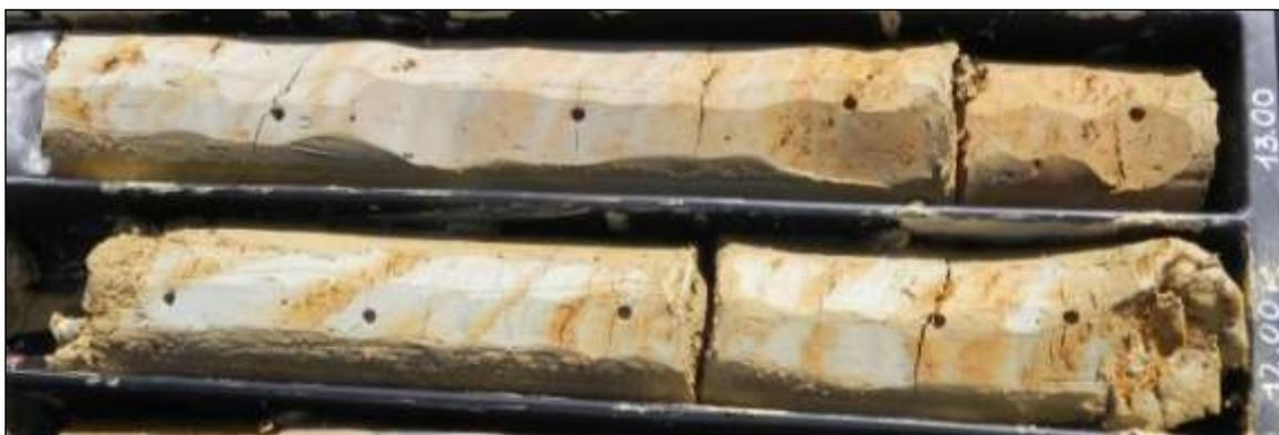
**FOTO 8** – Particolare argille limose [C2] del sondaggio **BH6** (11,50÷12,00 m e 12,50÷13,00 da p.c.).
