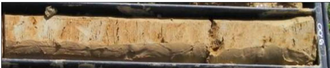
**FOTO 9** – Particolare limi sabbioso-argillosi [C1] del sondaggio **BH2** (8,50÷9,00 m da p.c.)
