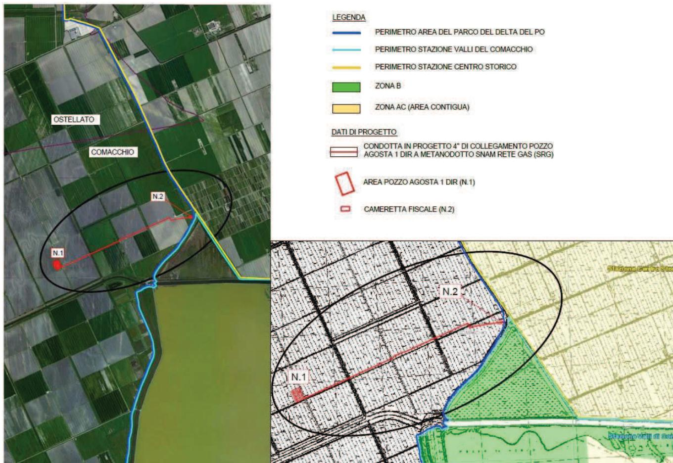
**Figura 3-1** Rappresentazione delle delimitazioni dell'Area Parco e delle Stazioni (sx) e della zonizzazione interna ad ogni stazione (dx). In rosso gli elementi di progetto.
