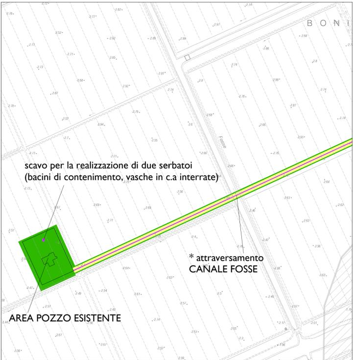
**CONDOTTA, settore centrale (DETTAGLIO 1:5.000)**
