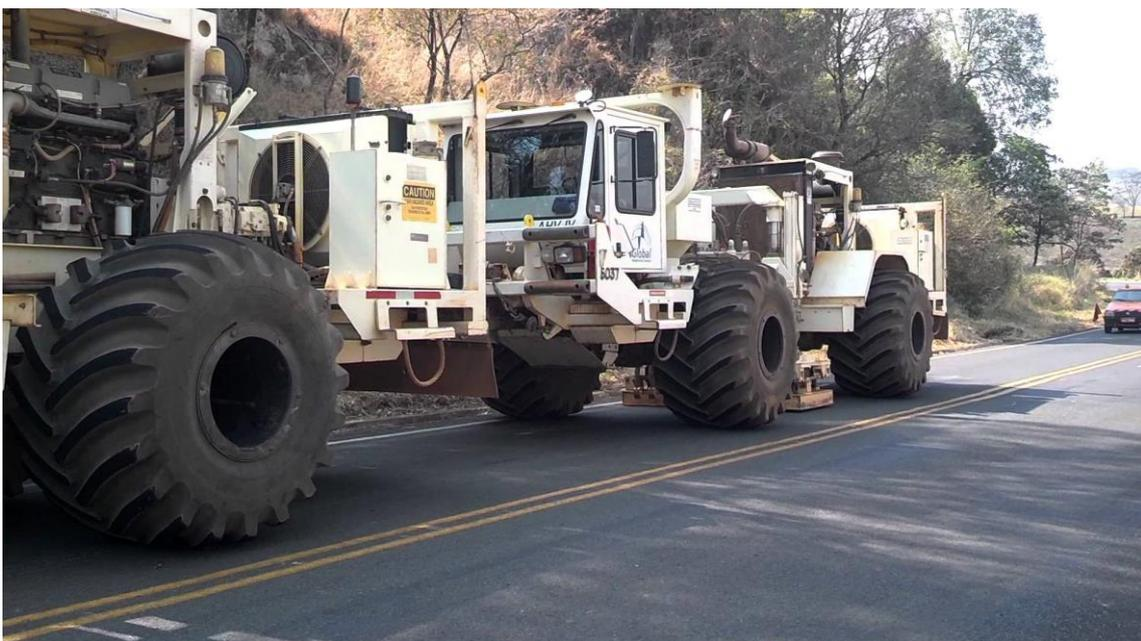
Figura 1-6. Vibroseis in fase di esecuzione del rilievo sismico.
