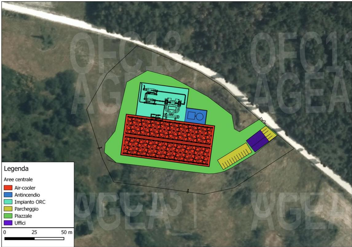
Figura 2-6. Aree centrale geotermoelettrica.
