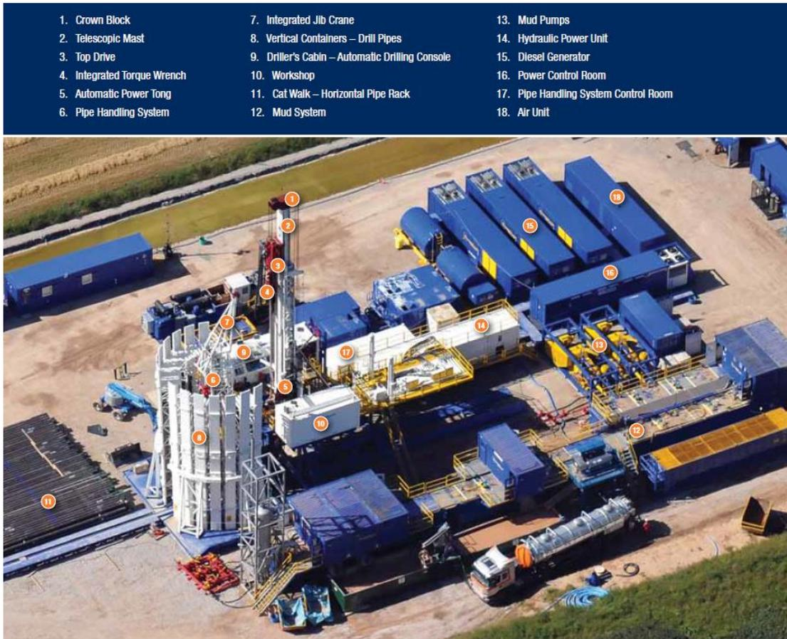
Figura 3-14. Esempio di impianto Drillemec serie HH.
