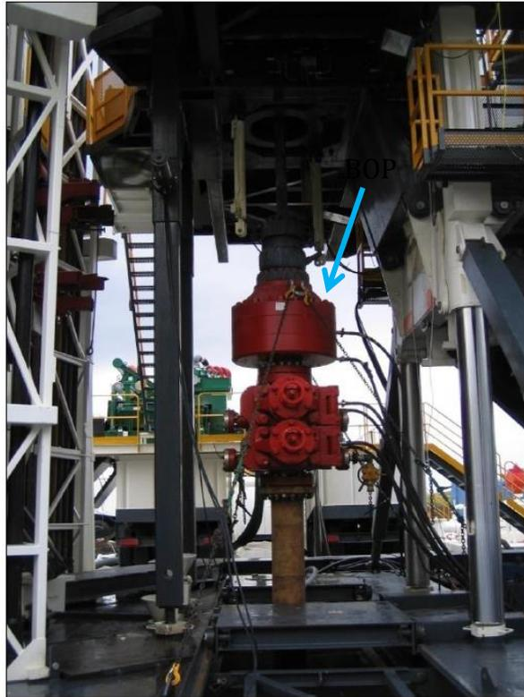
Figura 3-18. BOP montato su testa pozzo.
