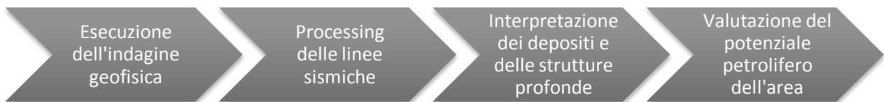
Figura 4.2 – Grafico schematico che mostra la successione delle fasi necessarie alla valutazione del potenziale petrolifero dell'area
