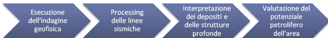
Figura 4.5 – Grafico schematico che mostra la successione delle fasi necessarie alla valutazione del potenziale petrolifero dell'area
