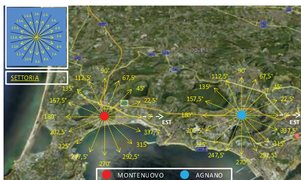
Figura 9.1.1. Localizzazione delle bocche eruttive di Agnano e Monte Nuovo, e direzioni del vento (= settori) assunte nelle analisi di impatto.
