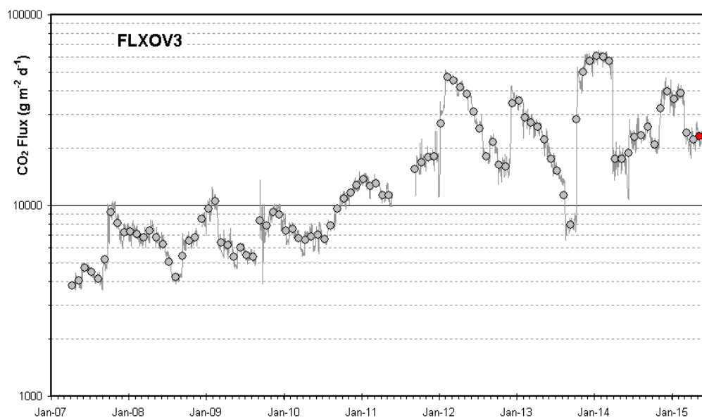
Figura 2.3.8 - Medie giornaliere (linea) e medie mensili (cerchi) dei flussi di CO 2 misurati a Pisciarelli (FLXOV3). E' da evidenziare il continuo trend d'aumento nel tempo del flusso CO 2 . La media mensile dei flussi relativa al mese di maggio, riportata con il simbolo rosso, non mostra significative variazioni rispetto al periodo precedente.
