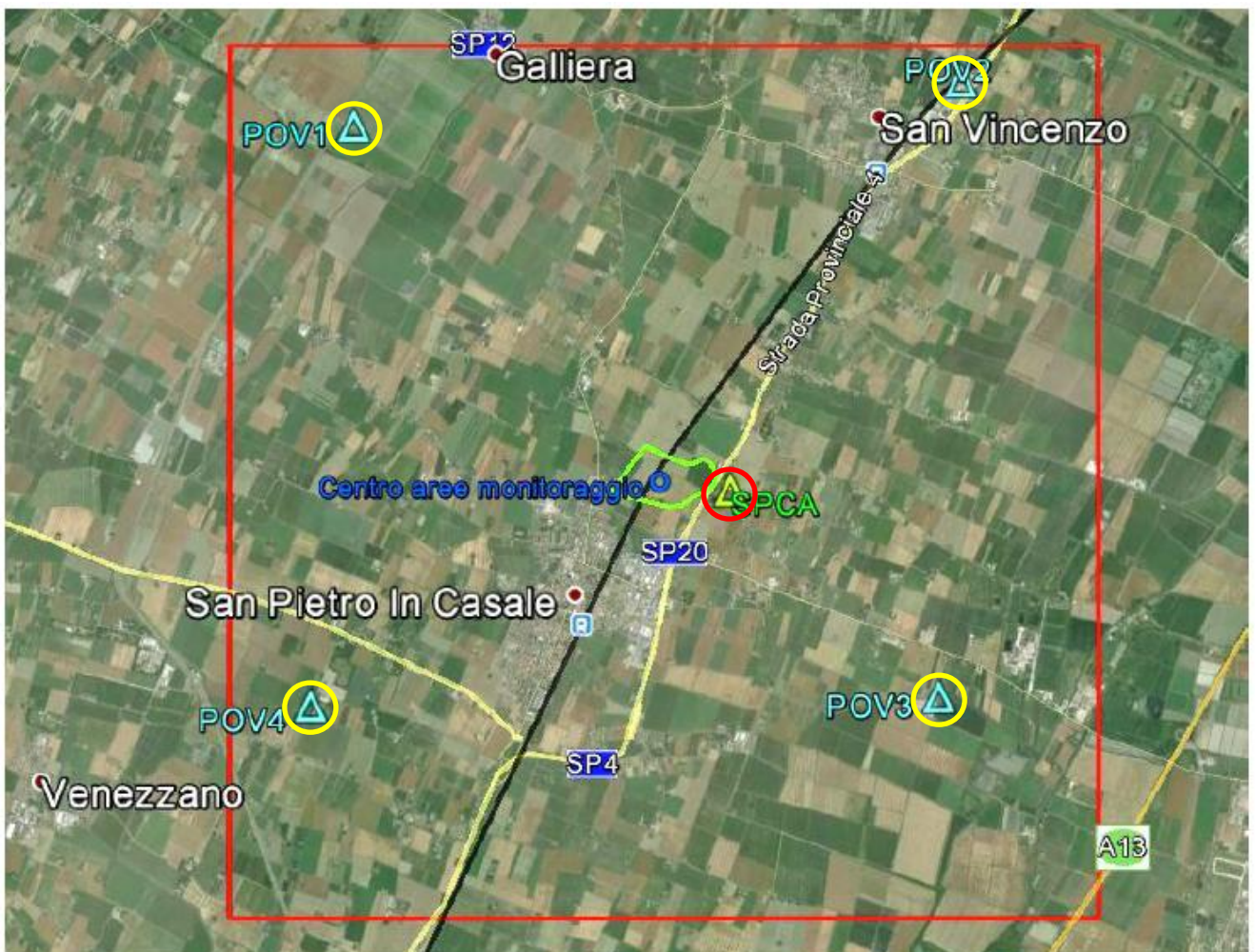
Fig. 7: Possibili ubicazioni delle stazioni sismiche (cerchi gialli e rosso) nel Dominio Interno (rettangolo rosso). La stazione ubicata presso l'area pozzo (cerchio rosso) verrà posizionata in foro a una profondità di circa 200 m
