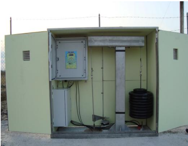
Fig. 4: assestimento “profondo” con relativo bilanciere e unità di acquisizione (sinistra); assestimento “superficiale” (destra)
