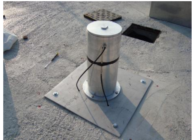
Fig. 4: assestimento “profondo” con relativo bilanciere e unità di acquisizione (sinistra); assestimento “superficiale” (destra)
