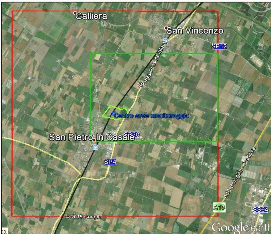
Fig.3: Dominio Interno di rilevazione (DI) (linea rossa) e proiezione in superficie del *reservoir* (linea chiusa verde chiaro) interessato dalla messa in produzione del pozzo Santa Maddalena 1 dir. Il rettangolo verde delimita la Concessione di coltivazione idrocarburi "S.Alberto". DI ha dimensioni: 8.6 x 8.6 x 4.0 km<sup>3</sup>.
