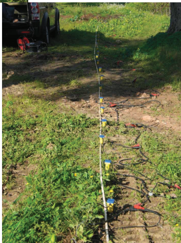
Foto 5 Particolare della stesa geofonica.
