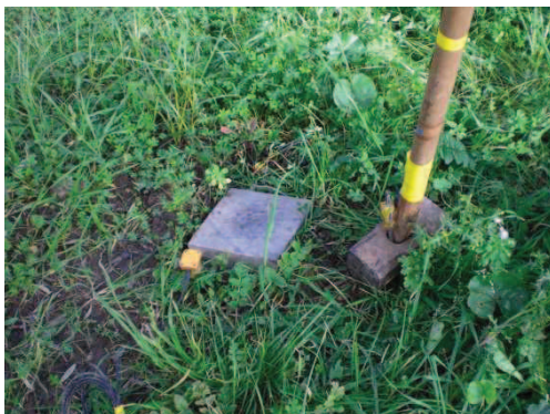
Foto 3 Il sistema energizzazione-trigger e la piastra di battuta
