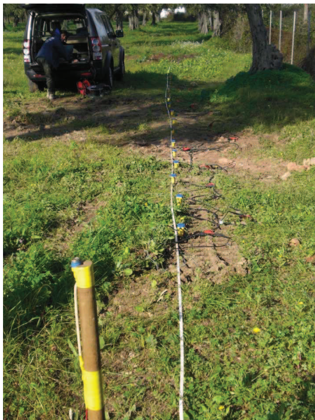
Foto 4 Lo stendimento sismico
