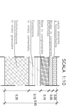
SEZIONE TIPO RAMPA MONODIREZIONALE
