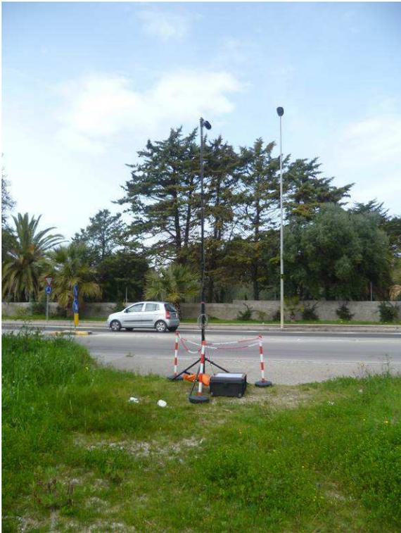
Figura 10: Documentazione fotografica del luogo di posizionamento del fonometro (misura settimanale).
