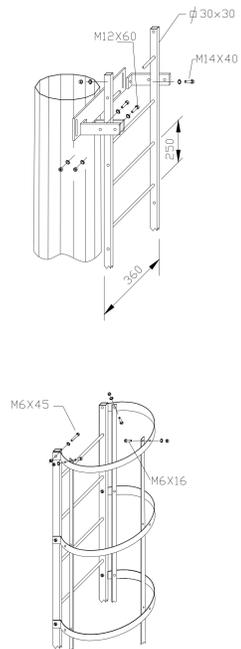
SISTEMA DI FISSAGGIO SU PLINTO TORRE 30m F.T.
