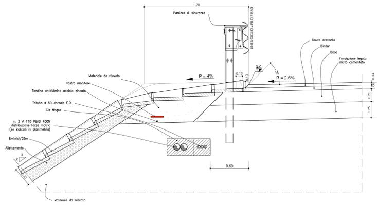
**SEZIONE IN RILEVATO SMALTIMENTO TIPO DETTAGLIO SCARICO IN CANALETTA IN CLS**
