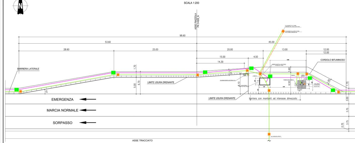
SEZIONE TIPO IN RILEVATO IN RETTIFILLO
