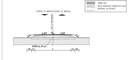
SEZIONE PISTA DI CANTIERE PROVVISORIA (TIPO C)
