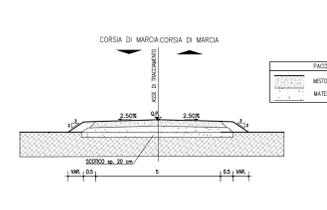
SEZIONE PISTA DI CANTIERE PAVIMENTAZIONE BITUMATA (TIPO B)
