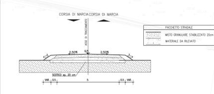
SEZIONE PISTA DI CANTIERE PAVIMENTAZIONE BITUMATA (TIPO B)
