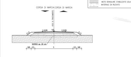
SEZIONE PISTA DI CANTIERE PROVVISORIA (TIPO C)
