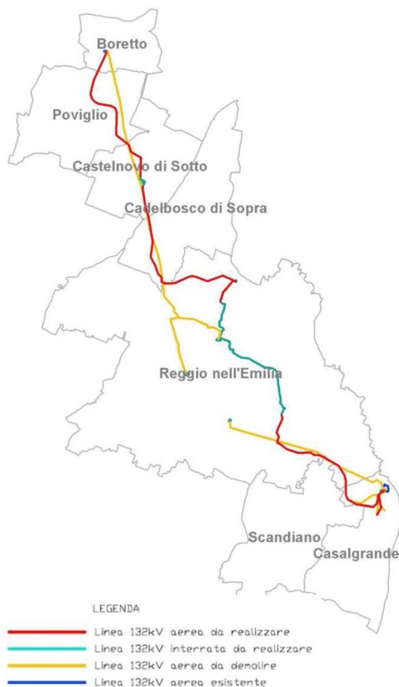
Figura 2.1-1: Prospetto dell'opera da realizzare.
