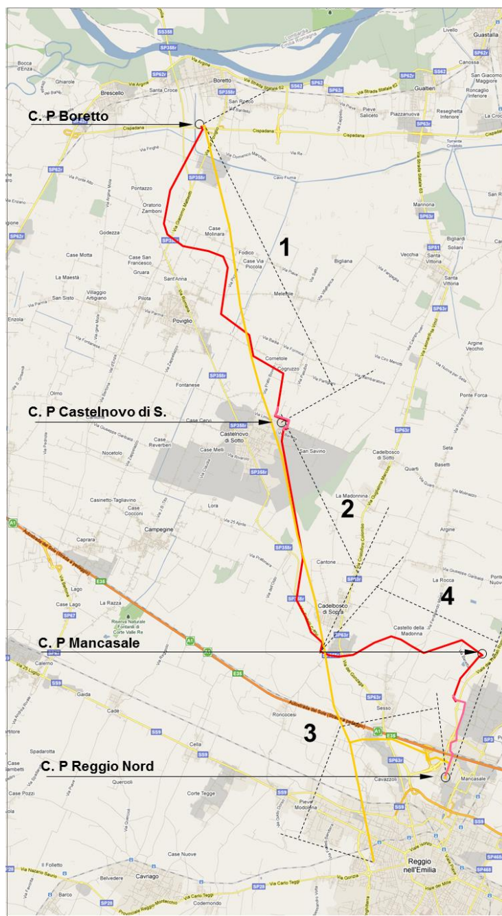
Figura 1 – Tracciato elettrodotto nel tratto C. P. Boretto – C. P. Reggio Nord (in rosso i tratti di nuova realizzazione, in giallo i tratti che saranno demoliti, in rosa i tratti di elettrodotto interrati, in blu i tratti di elettrodotto mantenuti in esercizio)
