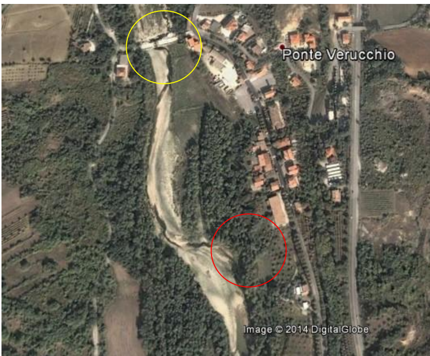
Fig. 2 - Fotogramma da google Earth anno 2008 – mese luglio. In rosso si evidenzia l'area in cui attualmente si è verificato il dissesto. In giallo si evidenzia l'esistenza della briglia ancora intatta.
