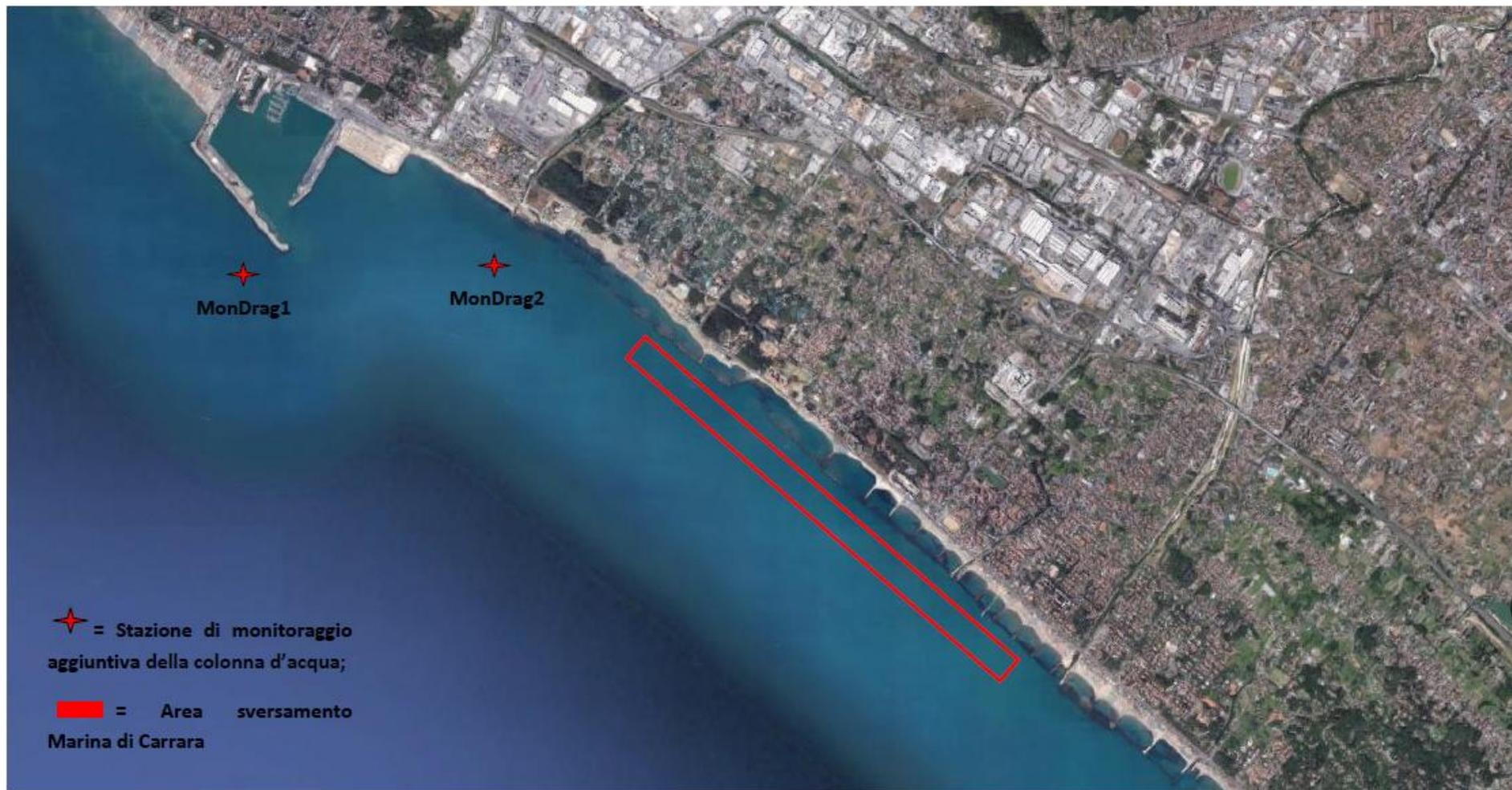
Figura 2 – Stazioni di campionamento aggiuntive inerenti l'area di dragaggio
