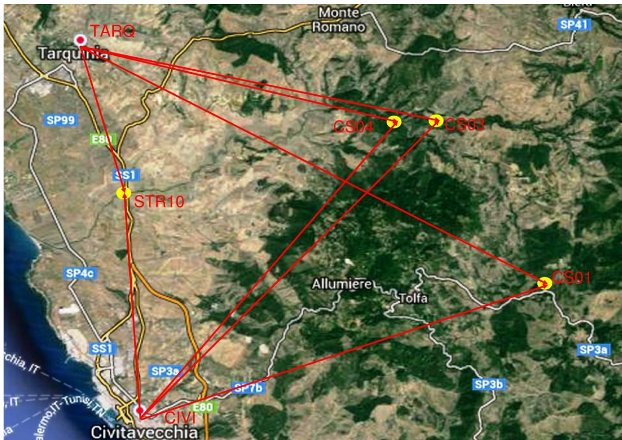
Figura 1 – Schema delle baseline tra i caposaldi e le stazioni permanenti
