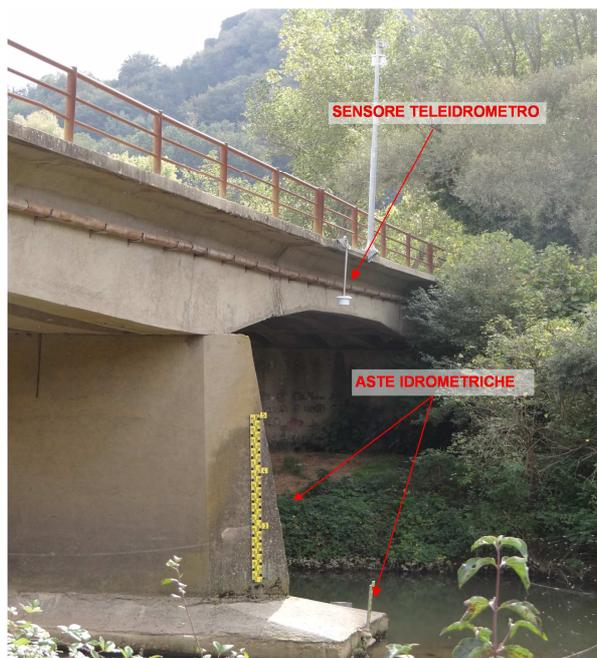
Figura 2.7. Aste idrometriche del Mignone ~~al ponte di Rota sul Mignone~~
