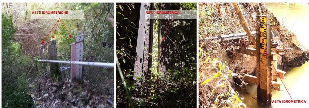
Figura 2.6. Aste idrometriche del Mignone a Rota teleferica
