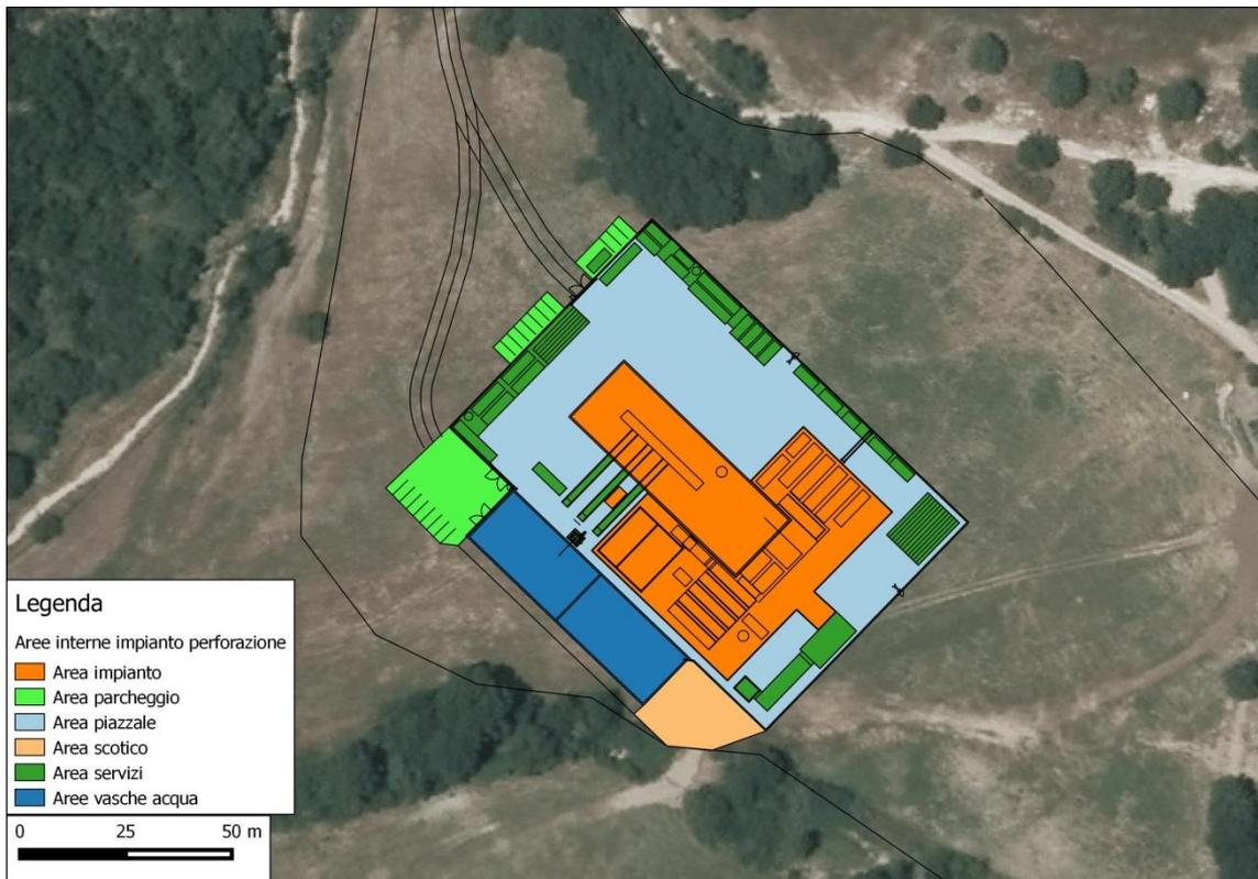
Figura 1-1. Layout postazione di perforazione Lucignano 1.
