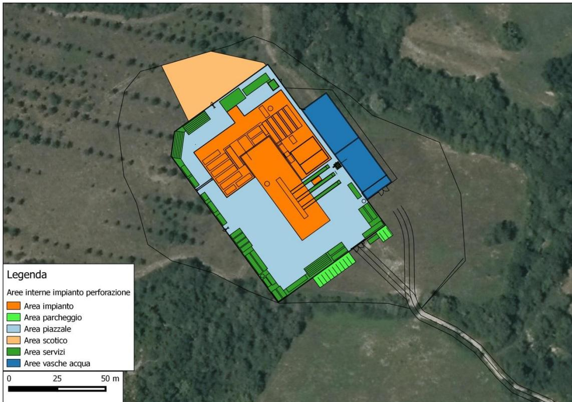
Figura 1-2. Layout postazione di perforazione Lucignano 2.
