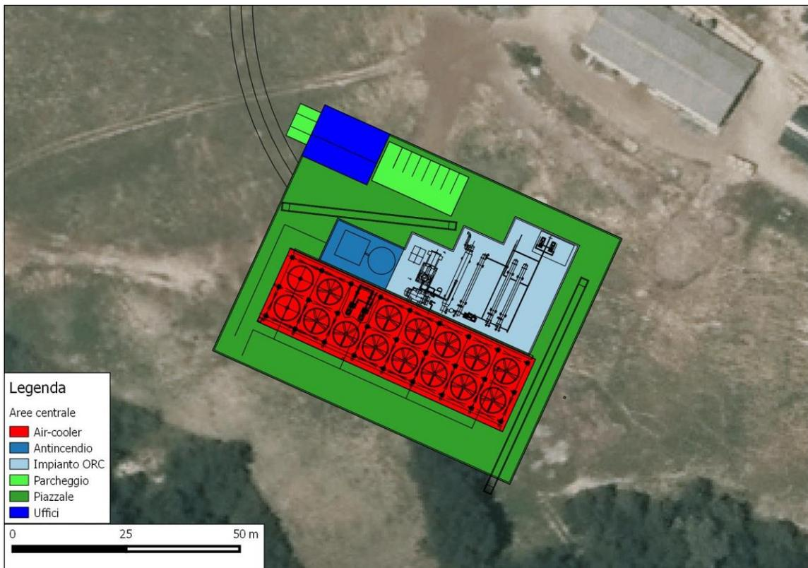
Figura 1-3. Layout centrale geotermoelettrica.
