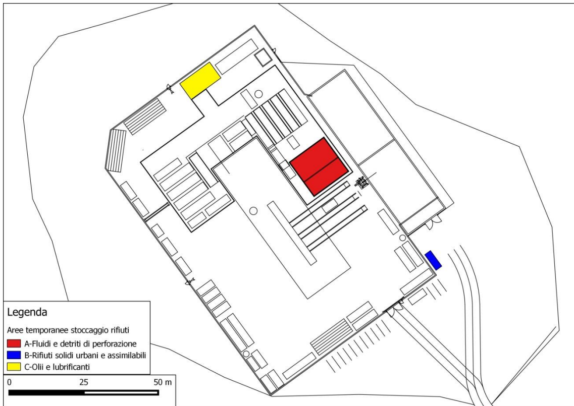
Figura 3-34. Ubicazione delle aree di stoccaggio temporaneo dei rifiuti nel cantiere di perforazione Lucignano 2.
