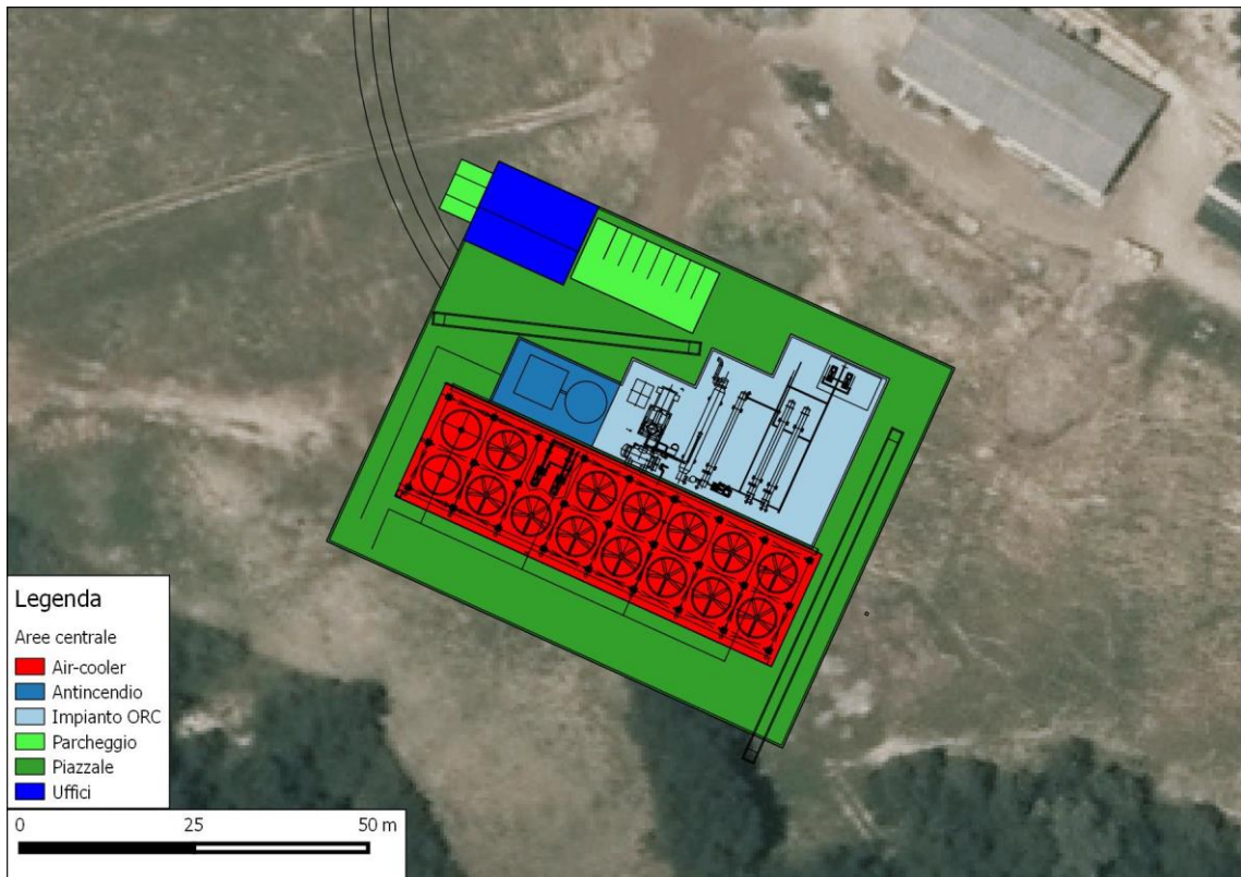
Figura 2-6. Aree centrale geotermoelettrica.
