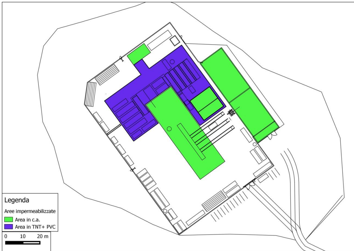
Figura 3-7. Individuazione delle aree impermeabilizzate e in cemento armato all'interno della postazione di perforazione Lucignano 2.
