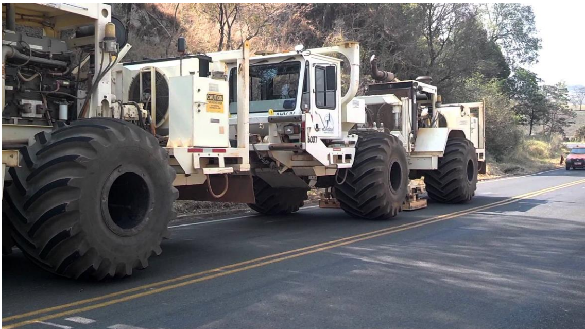
Figura 1-9. Vibroseis in fase di esecuzione del rilievo sismico.
